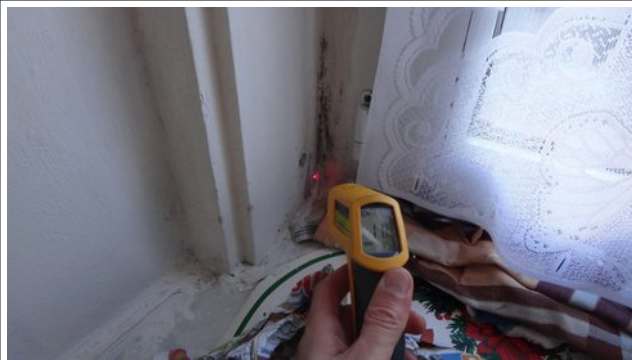
Fig. 7: Küche Fenster: niedere Oberflächentemperaturen und Schimmelbefall
